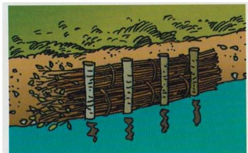
ÉLIMINATION D'ARBRES MENACÉS PAR L'ÉROSION ET FIXATION D'UNE BERGE BASSE INSTABLE PAR UN « FASCINAGE » DE BRANCHES VIVANTES DES SAULES
