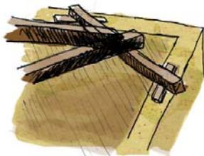
Une planche limite le poinçonnement des grosses pièces de charpente.
