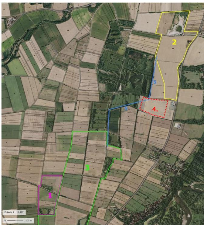
Localisation des différentes carrières et tracé projeté emprunté par les convoyeurs électriques
